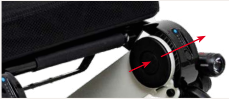
Abbildung 9: Den Akku wechseln
